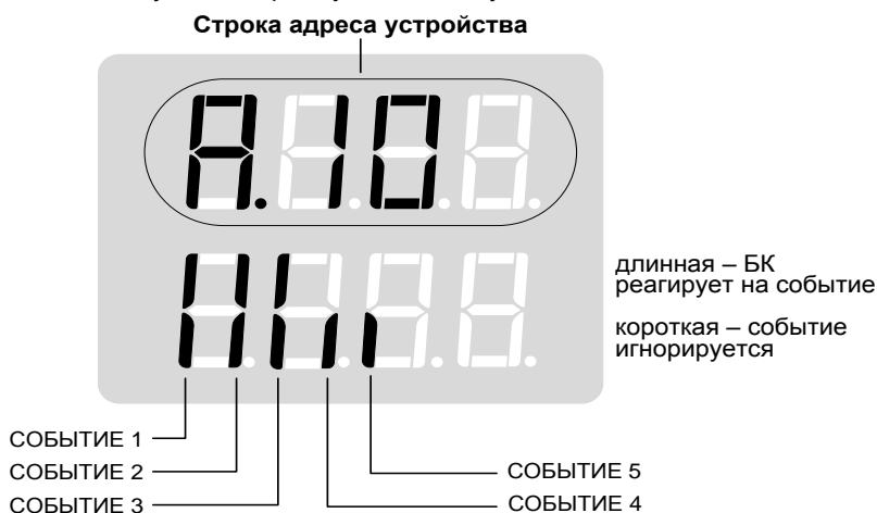
Рисунок 6 – Пример табло показывающего прибора при внесении записи в таблицу
