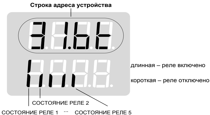
Рисунок 8 – Пример табло показывающего прибора при просмотре состояний реле БК
